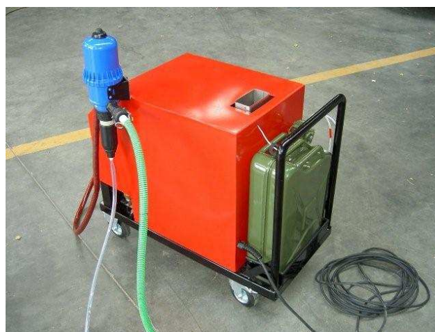
Przepliwowa nagrzewnica z dozownikiem chemii (niebieski zbiornik)
