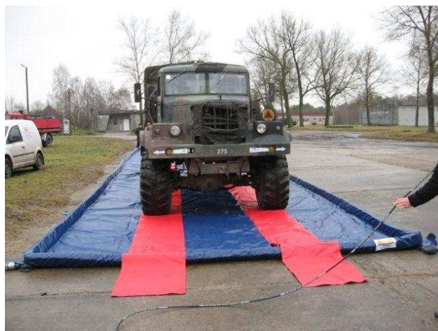
Kuweta umożliwia mycie ciężkiego sprzętu kołowego
