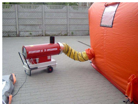
Nagrzewnica 25 kW podłączona namiotu NPA
