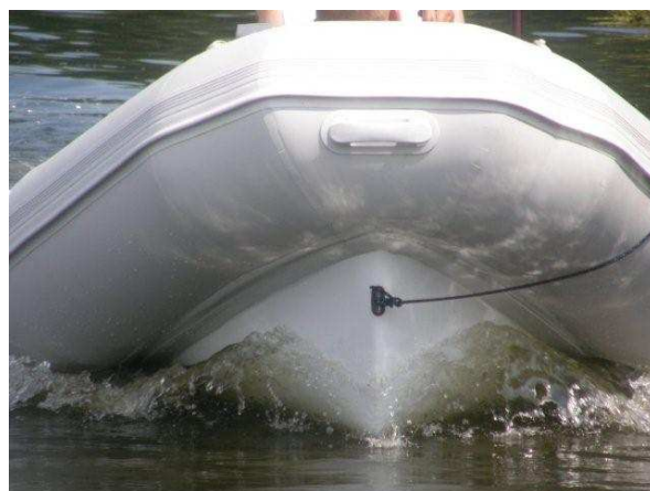
Połączenie pontonu z kadłubem z laminatu
