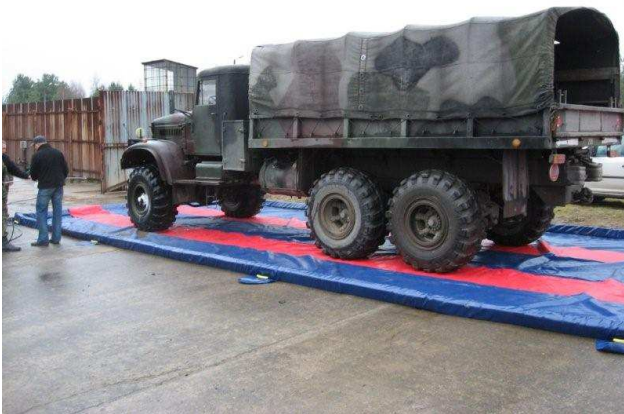
Reinigungs- und Desinfizierungsschale für Fahrzeuge
