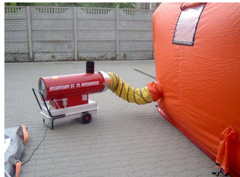
Erhitzer 25 kW an das Zelt NPA angeschlossen
