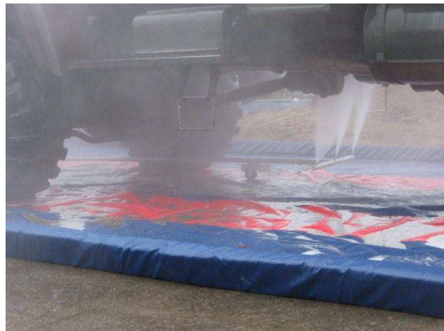
Schale – Desinfizierung und Reinigung des Fahrgestells
