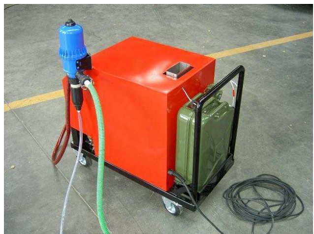
Durchlauferhitzer mit Dosiergerät für Chemie (blauer Behälter)
