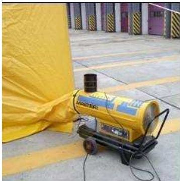
Erhitzer 14,5 kW an das Zelt NPA angeschlossen
